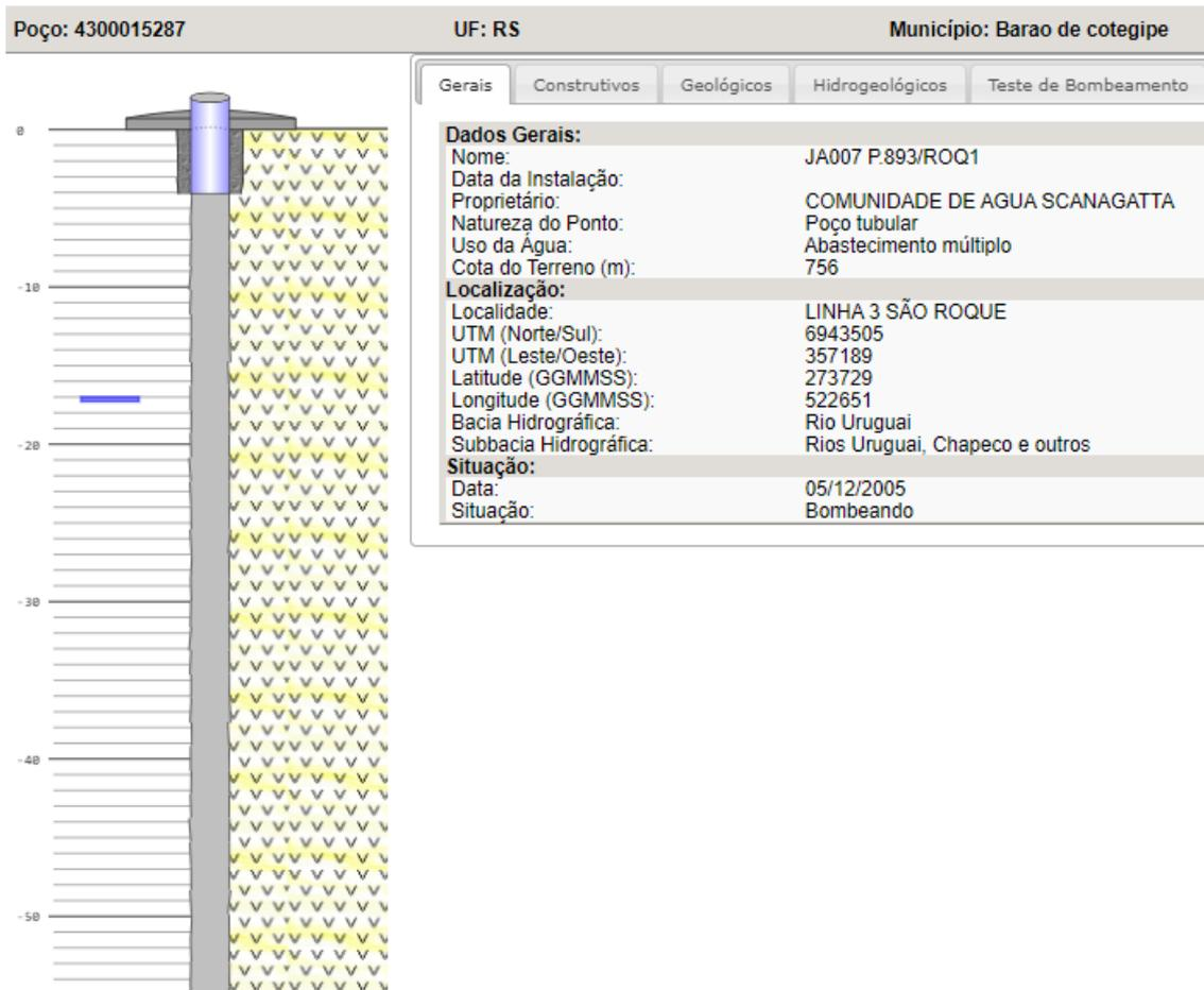
Figura 10: Perfil Geológico do Poço 1. Fonte: SIAGAS (2024).
