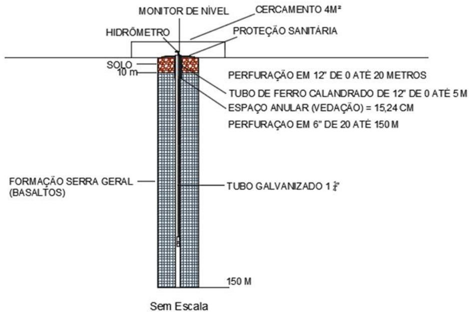
Figura 13: Perfil Construtivo do Poço. Fonte: Autor (2024).
